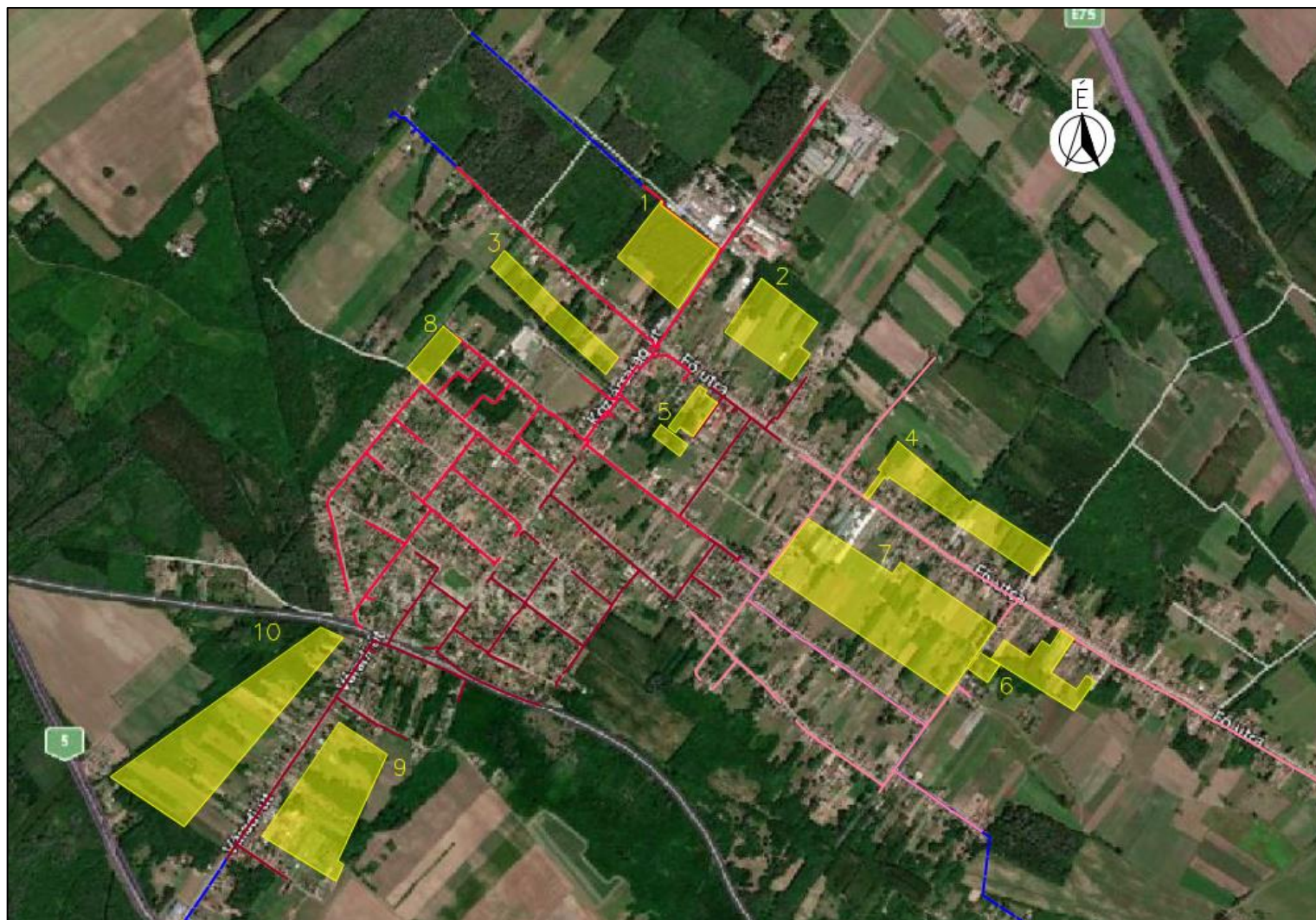
7.2. ábra – A csatornaszolgáltatásba bevonandó területek elhelyezkedése, valamint a meglévő hálózat 3 fő gyűjtő vákuumága Hernádon [Önkormányzati adatszolgáltatás]
